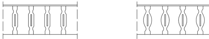
2. O gradeamento poderá ser executado em ferro forjado ou em ferro fundido de acordo com indicações fornecidas pela ATAHCA.
